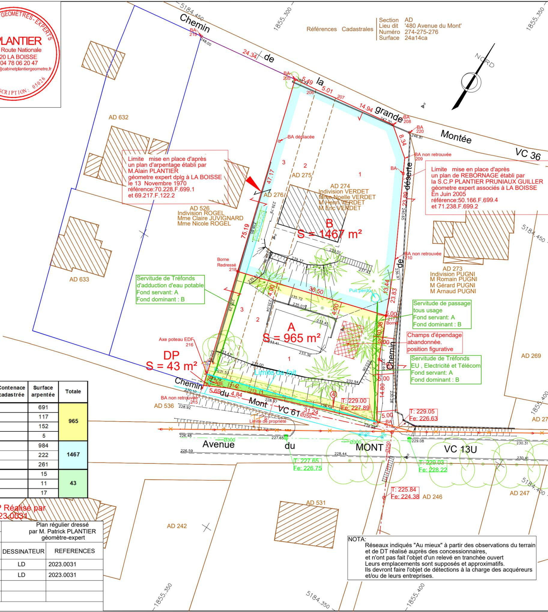
NOTA: Réseaux indiqués "Au mieux" à partir des observations du terrain et de DT réalisé auprès des concessionnaires, et n'ont pas fait l'objet d'un relevé en tranchée ouvert. Leurs emplacements sont supposés et approximatifs. Ils devront faire l'objet de détections à la charge des acquéreurs et/ou de leurs entreprises.
